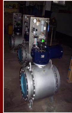
Actuadores Neumáticos de Doble Efecto (Yugo Escocés) para Válvulas de ¼ de vuelta de Operación (Esféricas, Mariposa, Tapón, etc.)
